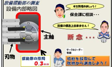
まず最初に、現地にて設備揺動部の切粉が挟まる隙間を測定しまして、**0.3mm**ある事がわかりました。保全課に隙間を塞げないか相談したところ、設備の構造上隙間はあるもので塞ぐのは難しいと説明され断念！それを受け、サークルリーダー若島さんから『**現場から情報を得よう！切粉を採取して調査を進めよう！**』とアドバイスがありみんなで切粉の調査を進めていく事になりました。
