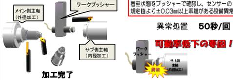
加工はメイン側とサブ側の2軸を持つ旋盤で行なっており、メイン側でバー材から外径加工をし、サブ側で受け取り、突っ切り刃具で切り離し、その後ワークブッシャーで着座確認し、内径加工され荒加工完了となります。ブッシャー異常とは、着座状態が規定値より±0.03mm以上乖離がある設備異常のことで異常処置に1回50秒かかり、可動率低下の大きな要因となります。
