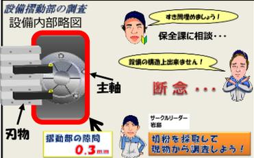
まず最初に、現地にて設備揺動部の切粉が挟まる隙間を測定しまして、**0.3mm**ある事がわかりました。保全課に隙間を塞げないか相談したところ、設備の構造上隙間はあるもので塞ぐのは難しいと説明され断念！それを受け、サークルリーダー若島さんから『**現場から情報を得よう！切粉を採取して調査を進めよう！**』とアドバイスがありみんなで切粉の調査を進めていく事になりました。
