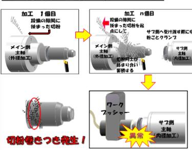
切粉が巻きつくメカニズムとして、メイン側で加工時の切粉が設備の隙間に挟まり、加工を繰り返すにつれ、切粉同士が絡まり合い、切粉が蓄積されていきます。サブ側へ受け渡す際にその切粉ごと製品を掴んでしまい切粉の巻きつきが発生します。
