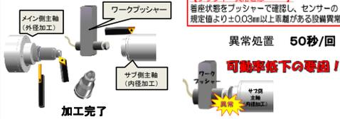
加工はメイン側とサブ側の2軸を持つ旋盤で行っており、メイン側でバー材から外径加工をし、サブ側で受け取り、突っ切り刃具で切り離し、その後ワークブラスで着座確認し、内径加工され荒加工完了となります。プッシャー異常とは、着座状態が規定値より±0.03mm以上乖離がある設備異常のことで異常処置に1回50秒かかり、可動率低下の大きな要因となります。
