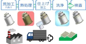
シートラインは、Φ15mmのバー材からNC機で荒加工、穴あけを行ない、社外にて熱処理を行ない、その後NC機で仕上げ加工を行ない、洗浄・全数検査を実施し、月におよそ4万台出荷しております。
